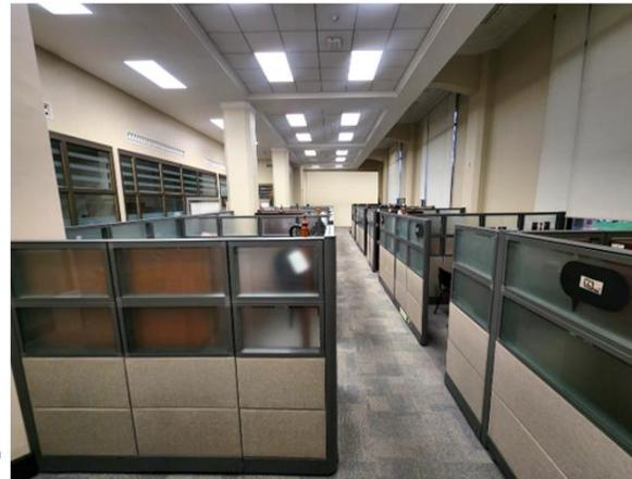
*Nota.* Se mantiene el cielo americano existente. La alfombra será protegida durante las faenas. Se retirarán los separadores modulares y se reemplazarán las luminarias de 120x60 cm, conforme a las especificaciones técnicas del proyecto (EETT).
