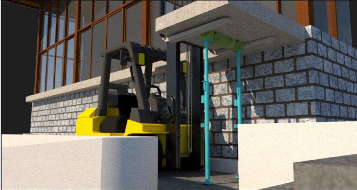
**Figura 29: Posicionamiento de la grúa horquilla, sosteniendo última franja de losa, previo a la demolición.**
