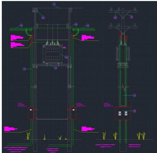
Ilustración 1: Disposición Transformador 150 kVA, plano adjunto en bases
