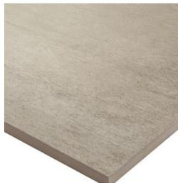
Se pegará con adhesivo tipo Bekron D.A. Se utilizará separador plástico. Se requiere la utilización de esquineros color de cerámica adecuados en todas las esquinas. Posteriormente, se aplicará fragüe color similar a cerámica en toda la superficie.
